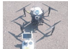
2017年 設備点検用マルチヘリコプタ (非GPS環境飛行可能、衝突防止機能)
