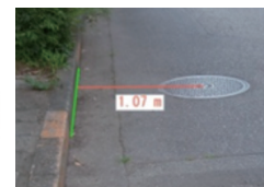
(計測例) マンホールと道路の距離を測定
